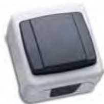
Выключатель одноклавишный проходной с пружинным зажимом 37064005 10 AX, 250 V~ EN 60669-1 К-во шт/пакет / К-во шт/коробка - 12 / 120
