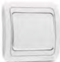
Выключатель одноклавишный 1 вход 3 выхода 12094 10 AX, 250 V~ EN 60669-1 К-во шт/пакет / К-во шт/коробка - 12 / 120
