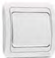
Выключатель одноклавишный * проходной 12005 10 AX, 250 V~ EN 60669-1 К-во шт/пакет / К-во шт/коробка - 12 / 120
