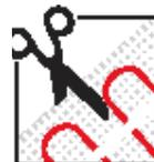
При укладке нагревательного мата должна разрезаться только основа (сетка). Кабель разрезать нельзя!!!
