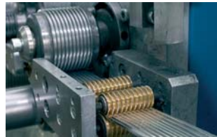
Цех изготовления гибких воздуховодов
