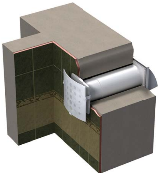
Вытяжка воздуха напрямую через стену
