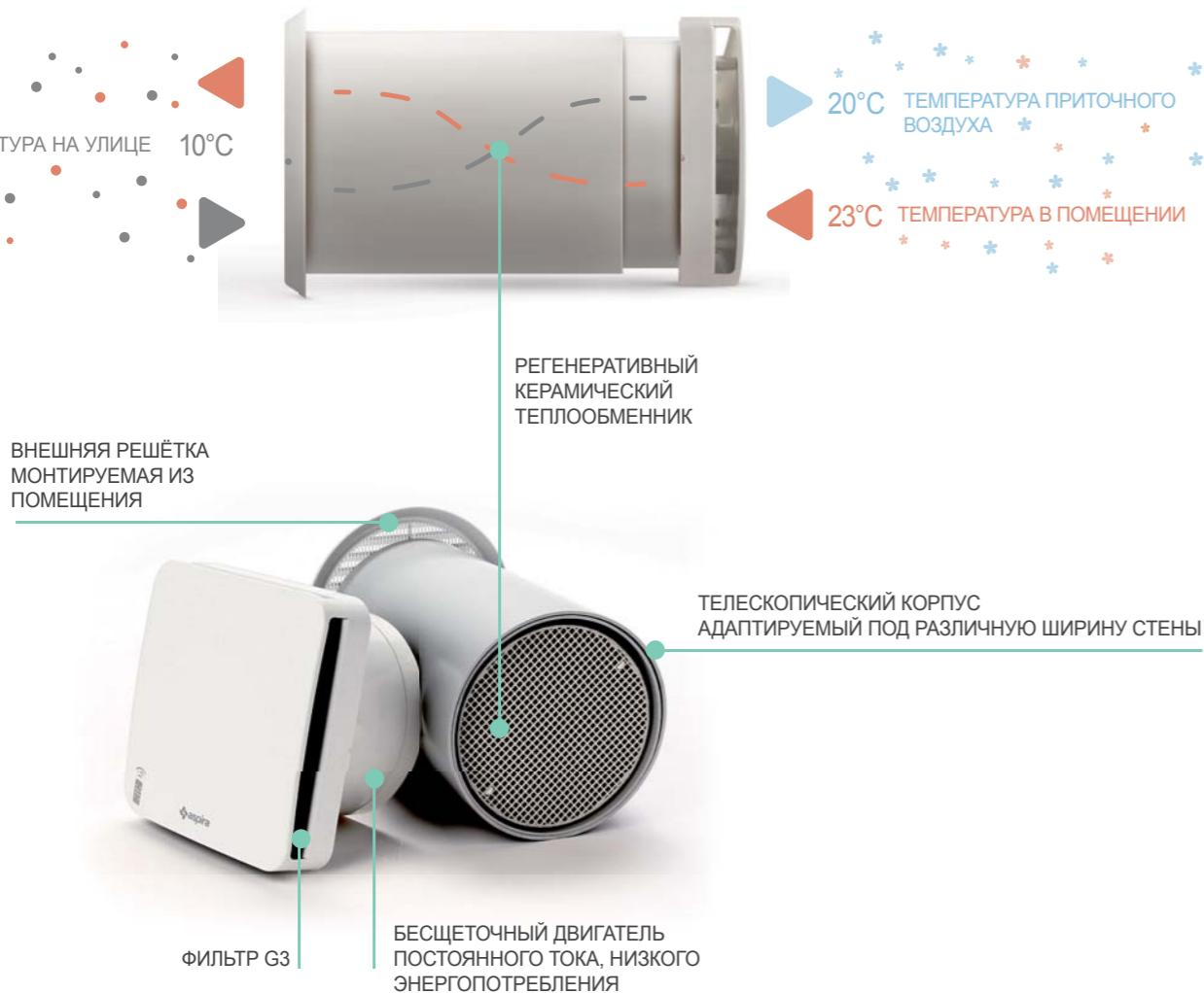
Вентиляционная установка ASPIRVELO AIR серии ECOCOMFORT должна устанавливаться на внешней стене помещения. Благодаря телескопическому корпусу, устройство легко адаптируемо к различным толщинам стен: минимальная ширина 24 см, максимальная ширина 58 см. Кроме этого, монтаж установки облегчается благодаря оригинальной конструкции внешней решетки, которую можно устанавливать изнутри помещения.
